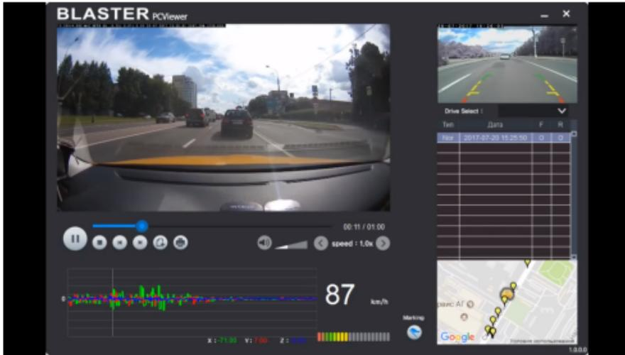
Благодаря наличию GPS-модуля и с помощью специального плеера **INTEGO** можно просматривать записанные видеофайлы на компьютере. При этом на карте **Google** отображается местоположение автомобиля и скорость его движения. Помимо традиционных функций (воспроизведение, пауза, просмотр следующего/предыдущего видеофайлов), плеер отображает работу G-сенсора.
